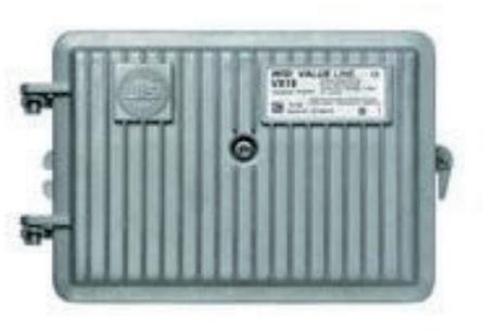
Fernspeisbarer BK Hausanschluss oder Strecken Verstärker nachgeschaltet einem Übergabepunkt zur Pegelanhebung für ein nachfolgendes koaxiales Verteilnetz, empfohlen für 12-24 WE, Einstufung nach 1 TS 140 D 4.4, Kaskadenbetrieb, Netzbetriebzulassung
