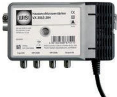
Der VX 43 0C 065 ist ein ortsgespeister Hausanschlussverstärker mit einem Frequenzbereich bis 1,2 GHz, er verfügt über einen aktiven Ausgang und eine externe Messbuchse am Eingang sowie am Ausgang. Diplexfilter und Rückwegverstärker sind auf einem Modul (VX 40 0C xxx) zusammengefasst und in den Varianten 65 MHz und 204 MHz verfügbar. Alle Einstellungen werden über Jumper vorgenommen. Vodafone Deutschland Kategorie D (1.2).
