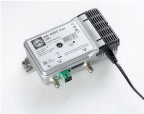
Der LR91 ist ein kompakter Empfänger für CATV-Verteilnetze und RF-Overlay. Hoher Ausgangspegel bis 100 dB $\mu$ V und Frequenzbereich bis 1 GHz.
