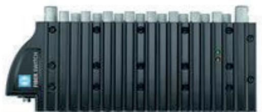
Erweiterungs-Multischalter mit optischem Eingang, für 8 Teilnehmer. Kosteneffiziente Installation da Patchkabel zwischen optischem Rückumsetzer und Multischalter entfallen. Umsetzung eines Satelliten. Spannungsversorgung über Basis-Multischalter OL 41 0008.
