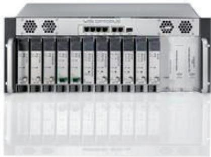
LX 50 0230 ist eine Grundeinheit der optischen Übertragungsplattform Optopus mit 14 Modulsteckplätzen in 4 Höheneinheiten, mit einer Versorgungsspannung von 230 V AC.
