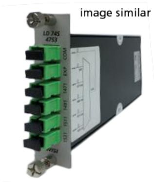
Optischer 4 Kanal DWDM Multiplexer / Demultiplexer (K.30...K.33) mit Expressport (1460...1620 nm) für den Einsatz in den WISI Chassis LX 50 und LP 40.
