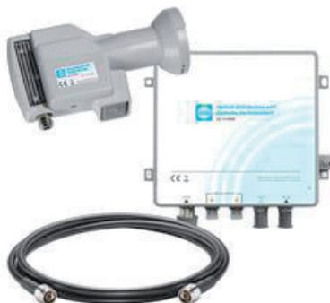
Paket zur Umsetzung von einem Satellit, DVB-T/T2, DAB und UKW in ein optisches Ausgangssignal. Paket besteht aus: Vollband-LNB mit N-Anschluss, Elektrisch/Optischer Wandler, N-Verbindungskabel (2m), Netzteil und Montagekit zur direkten Befestigung am Antennenmast.
