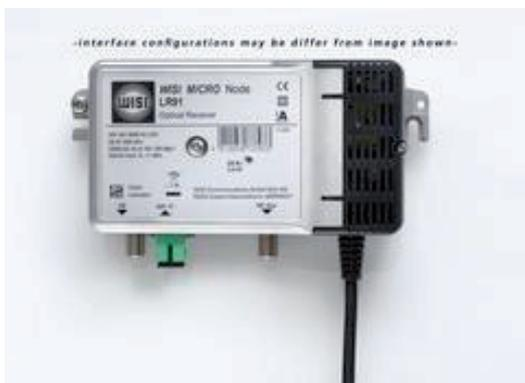
Der LR 91 W ist ein kompakter Empfänger für CATV-Verteilnetze und RF-Overlay. Das integrierte WDM Filter ermöglicht die Auskopplung der zusätzlich zum CATV anliegenden xPON Wellenlängen. Er besitzt einen hohen Ausgangspegel bis 100 dB $\mu$ V im Frequenzbereich bis 1 GHz.
