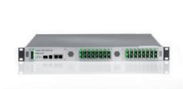
LX 35 xxx ist ein optischer Hochleistungsverstärker auf YEDFA Basis für den Einsatz in CATV und FTTx Netzen. Das Gerät ist verfügbar mit unterschiedlicher Ausgangsleistung und Anzahl an Ausgangsports.
