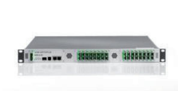
LX 35 xxx ist ein optischer Hochleistungsverstärker auf YEDFA Basis für den Einsatz in CATV und FTTx Netzen. Das Gerät ist verfügbar mit unterschiedlicher Ausgangsleistung und Anzahl an Ausgangsports.
