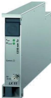
Der LX 11 ist Teil der Optopus Produktfamilie. LX 11 ist ein einzelner direkt modulierter Vollbandsender mit 1310 nm für den Einsatz in HFC-Netzwerken. Die Optopus-Plattform ist eine hochflexible und hochdichte Plattform für alle Arten von analogen optischen Netzwerken. Das System wird in jedem Netzwerk wie HFC, RF over Glass oder RF Overlay in FTTH-Anwendungen eingesetzt.
