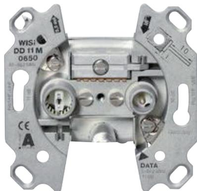
TV-Anschlüsse in IEC-Technik. Multimedia (DATA) mit F-Buchse für Kabelmodem. HF-Ausgang hochpassgefiltert. Abdeckplatte und Anschlußkabel siehe Zubehör.
